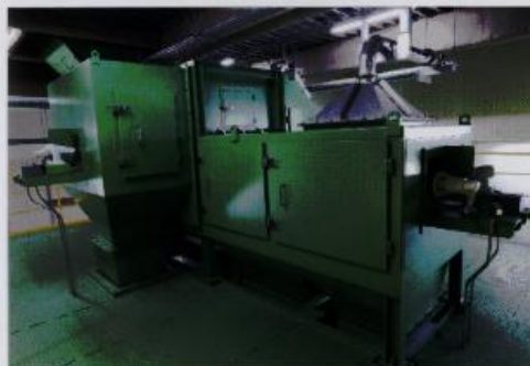
スチール缶磁選機・アルミ缶選別機 磁石によってスチール缶、アルミ缶及び異物に選別します。
