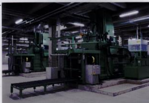
食品包装プラスチック梱包機 選別された食品包装プラスチックを圧縮し、梱包します。
