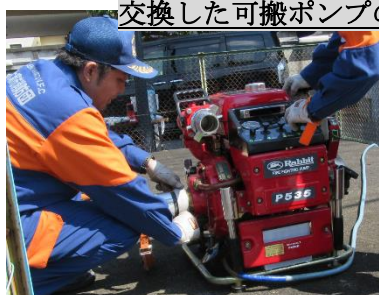
交換した可搬ポンプの操作手順説明
