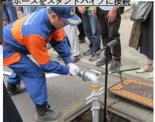
ホースをスタンドパイプに接続
