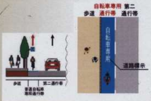
自転車レーンの標準的な幅員イメージ
