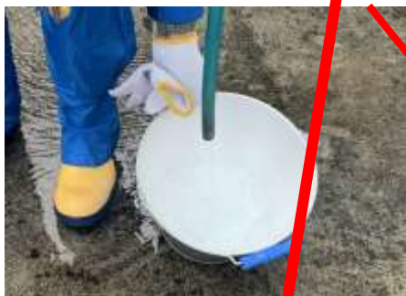
塩素濃度の確認作業(ピンク色が付けば飲料可能)
