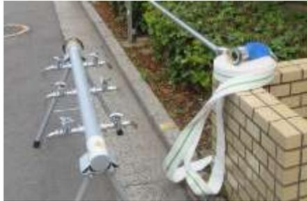
災害対策用応急給水栓の部品確認
