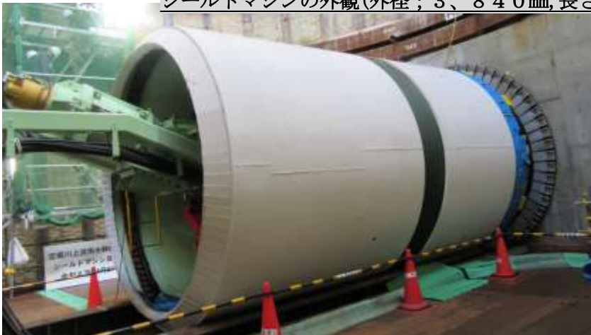
シールドマシンの外観(外径; 3,840mm,長さ; 6,310mm)
