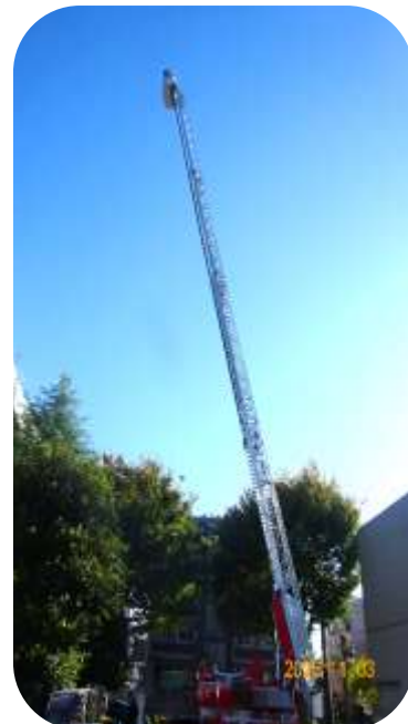
地上30m ビルの10階に到達
