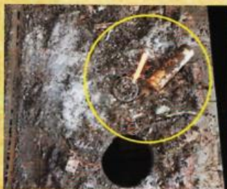
携帯型扇風機焼損状況
